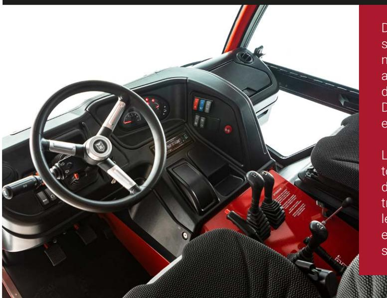
Die Kabine, als Überrollschutzsystem zugelassen, besitzt eine hohe strukturelle Festigkeit. Die großen Glasflächen gewährleisten eine maximale Sichtbarkeit während der Arbeit, die Fahrposition und alle Bedienelemente und Hebel sind angeordnet, um sowohl auf der Straße als auch im Gelände einen hohen Komfort zu bieten. Das Kabinenkippsystem, schnell und ohne Werkzeug, ermöglicht einfache und schnelle Wartungsarbeiten.
