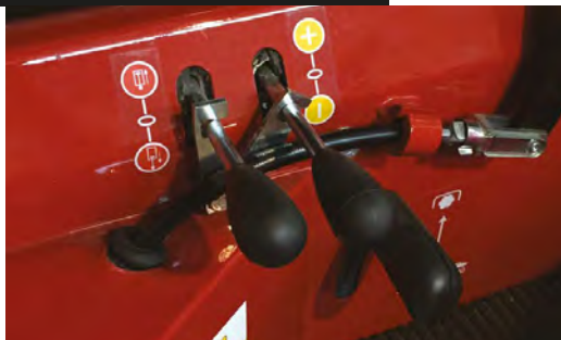
Hydraulischer Verteiler mit 2 Hebeln und 3 Schnellkupplungen hinter dem Sitz. Distributeur hydraulique à 2 leviers avec 3 raccords rapides derrière le siège.
